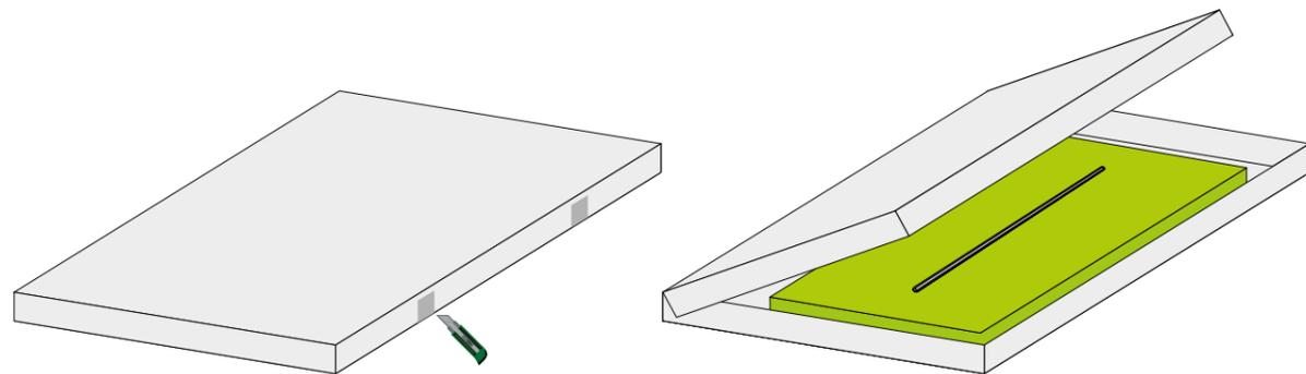
Die Akustikleuchte muss am Rahmen\* an der kurzen Seite gefasst und transportiert werden. Sie darf nicht alleine getragen werden. Tragen Sie die Leuchte immer zu zweit und ausschließlich hochkant. Benutzen Sie Baumwollhandschuhe, um das Absorbermaterial nicht zu beschmutzen.
