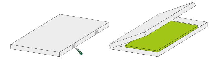
Die Akustikleuchte muss am Rahmen gefasst und transportiert werden. Die Leuchte darf nicht alleine getragen werden\*. Tragen Sie die Akustikleuchte möglichst zu zweit\* und ausschließlich hochkant. Benutzen Sie Baumwollhandschuhe, um das Produkt nicht zu beschmutzen.
