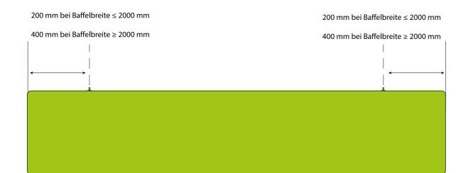
Übertragen Sie die zuvor ermittelten Maße der Drahtseilabhänger an die Decke und markieren Sie die Bohrpunkte.
