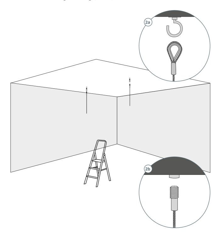
Die Drahtseile werden in die Drahtseilhalter eingefädelt. Durch integrierte Rohre in der Pendelleuchte können die Drahtseile nach oben und unten nachjustiert werden.
