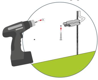
3. Befestigen Sie das Vorschaltgerät mit passenden Schrauben an der Decke oder dem Deckenhohlraum.
