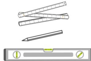
Um die Abstände der Bohrlöcher zu ermitteln, messen Sie den Abstand von der Mitte der rechten Aussparung des Wandabsorbers bis zur Mitte der linken Aussparung. Übertragen Sie die gemessenen Abstände auf die Wand und zeichnen Sie die Bohrlöcher an. Verwenden Sie bitte die Wasserwaage, um die beiden Punkte exakt horizontal auszurichten.
