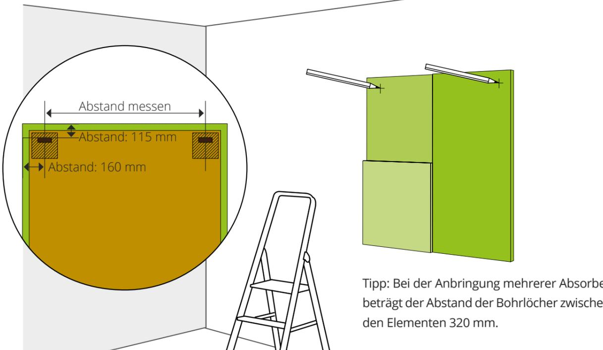
Tipp: Bei der Anbringung mehrerer Absorber beträgt der Abstand der Bohrlöcher zwischen den Elementen 320 mm.
