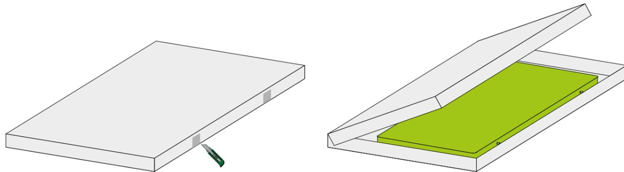
Die Absorber müssen am Rahmen\* an der kurzen Seite gefasst und transportiert werden. Der Akustikabsorber darf nicht alleine getragen werden. Tragen Sie immer die Akustikamente zu zweit und ausschließlich hochkant. Benutzen Sie Baumwollhandschuhe, um den Akustikabsorber nicht zu beschmutzen.
