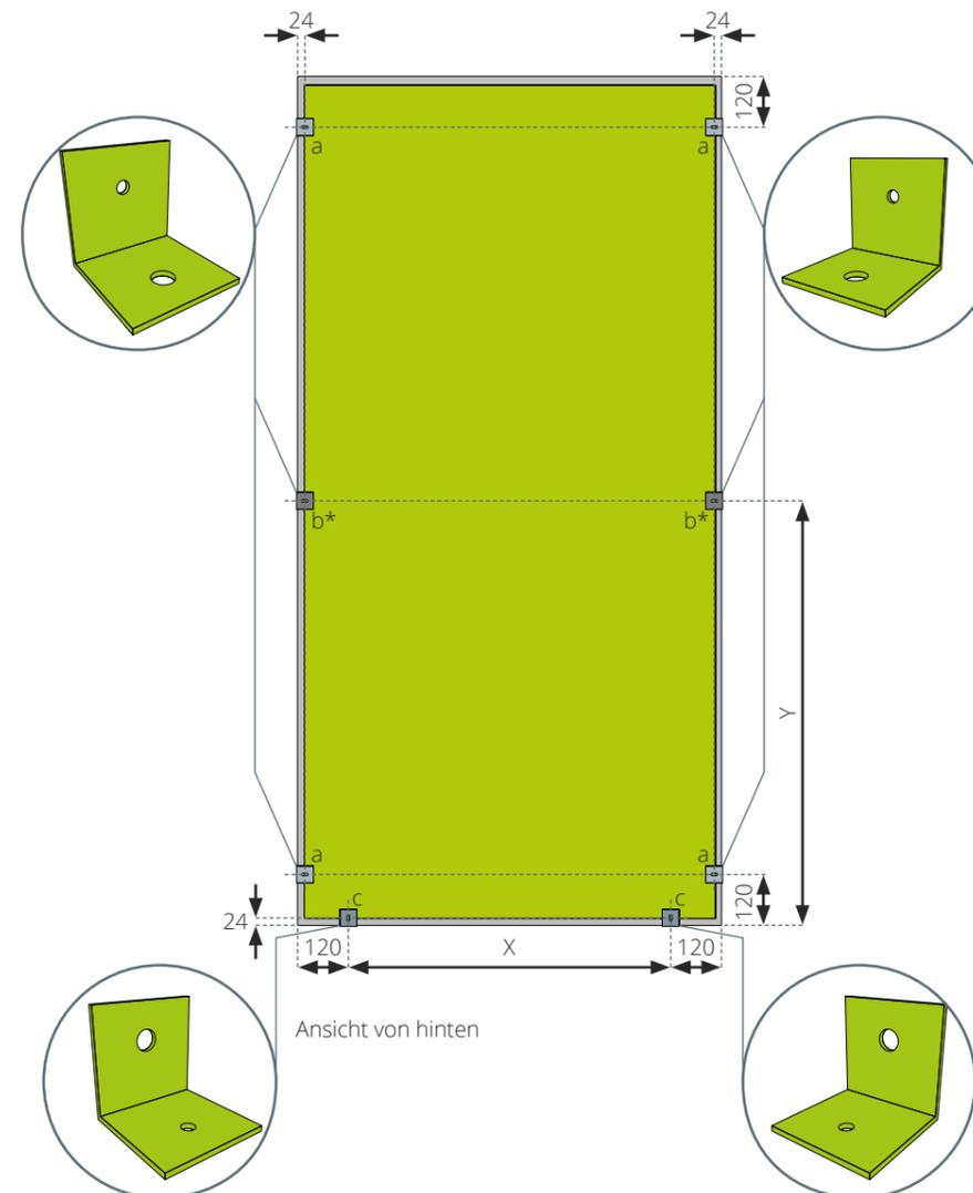
Alle Maßangaben in mm. | \* Ab einer Absorberhöhe von 2 m werden drei Langlochwinkel pro Seite empfohlen.
