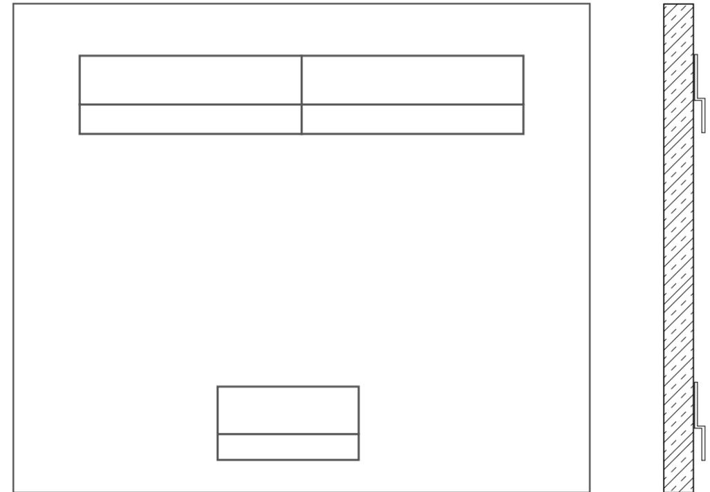
Am Akustikwandabsorber befinden sich rückseitig ein oder mehrere apn sys-z-Profile, die der Montage der apn Forma dienen. Das untere apn sys-z-Profil dient als Abstandhalter zur Wand. Das obere apn sys-z-Profil dient der Aufhängung.
