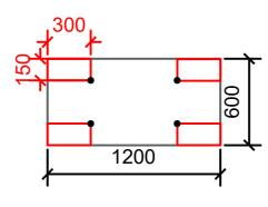
An den markierten Punkten drehen Sie nacheinander die vier Spiralfedern ein. Bitte beachten Sie, dass die Spiralfedern maximal 3 cm in die Akustikleuchte eingedreht werden dürfen, um ein Durchbohren zu verhindern. Die Haken der Spiralfedern zeigen hierbei nach oben.
