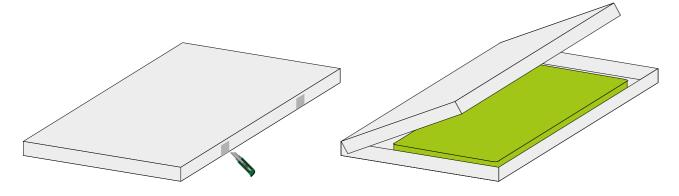
Die Akustikleuchten müssen am Rahmen\* an der kurzen Seite gefasst und transportiert werden. Die Akustikleuchte darf nicht alleine getragen werden. Tragen Sie immer die Akustikleuchten zu zweit und ausschließlich hochkant. Benutzen Sie Baumwollhandschuhe, um die Leuchten nicht zu beschmutzen.
