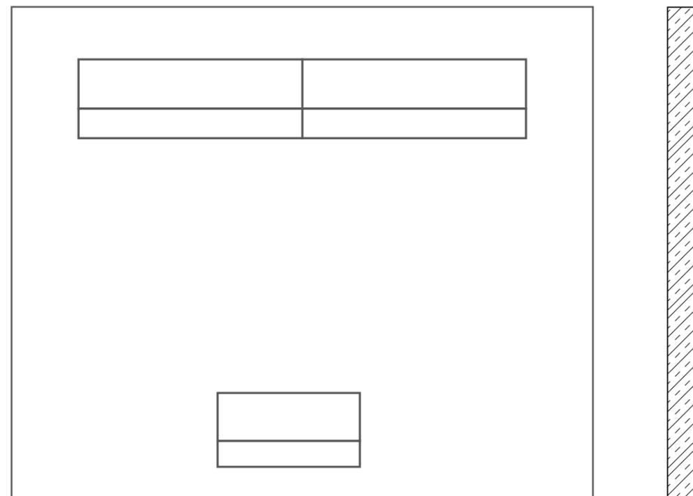
Am Akustikwandabsorber befinden sich rückseitig ein oder mehrere apn® sys-z-Profile, die der Montage der apn® Forma A dienen. Das untere apn® sys-z-Profil dient als Abstandhalter zur Wand. Das obere apn® sys-z-Profil dient der Aufhängung.
