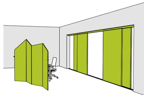
Die mobile Akustikwand apn® Area Flex Luv bedient sich eines Gleitsystems auf zwei Führungsschienen und kann einen großen Raum in zwei kleinere teilen oder nur einen Teilbereich eines Raumes akustisch und optisch abschirmen. Der Akustik-Paravent apn® Gig XL ermöglicht die schnelle Schaffung neuer Räume. Er ist einfach in der Handhabung, lässt sich schnell auf-/abbauen, verstauen und problemlos mit weiteren apn® Gig XL kombinieren.
