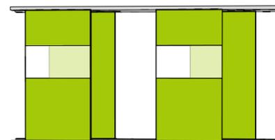
Das verschiebbare Akustikmodul apn® Area Flex Luv ist eine innovative Lösung, die eine flexible Raumteilung und höchste Schallabsorption in einem vereint. Hierbei bedient sich das Produkt eines Gleitsystems auf zwei Führungsschienen und kann einen großen Raum in zwei kleinere teilen oder nur einen Teilbereich eines Raumes akustisch und optisch abschirmen.
