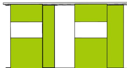
Das verschiebbare Akustikmodul apn® Luv ist eine innovative Lösung, die eine flexible Raumteilung und höchste Schallabsorption in Einem vereint. Hierbei bedient sich das Produkt eines Gleitsystems auf zwei Führungsschienen und kann einen großen Raum in zwei kleinere teilen oder nur einen Teilbereich eines Raumes akustisch und optisch abschirmen.
